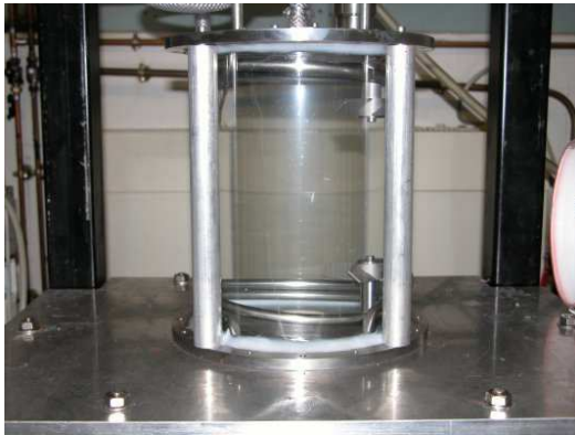
FIG. 2.3 – Photo de l’enceinte avec la paroi latérale en plexiglass.
