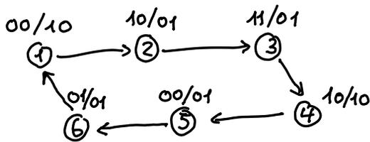
② Fonctionnement à débit maximal : les deux moteurs sont en marche simultanément aussi longtemps que possible. On éteint M quand un emballage a quitté la zone de détection, ou N lorsque deux produits sont passés.
