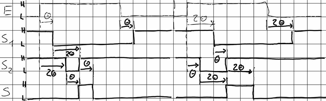
Le chemin de propagation le plus long entre E et S comporte deux inverseurs et une porte NAND. On pourrait donc s'attendre à des changements d'état jusqu'à  $2\tau_1 + \tau_2$  après le dernier changement d'état de E.
