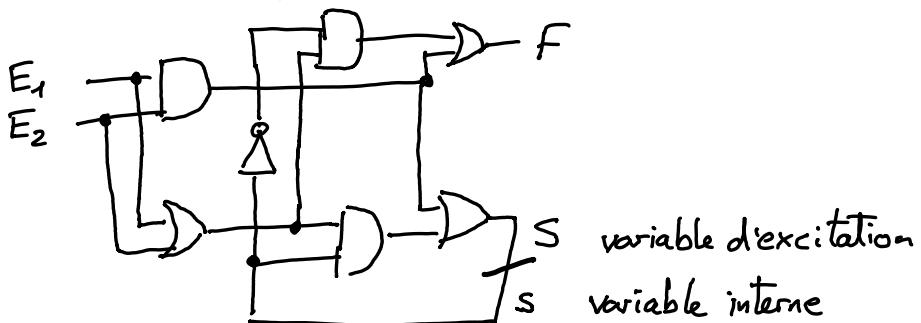
Il n'y a plus de boucle après cette coupure, une variable interne suffit donc à coder la mémoire du circuit.
