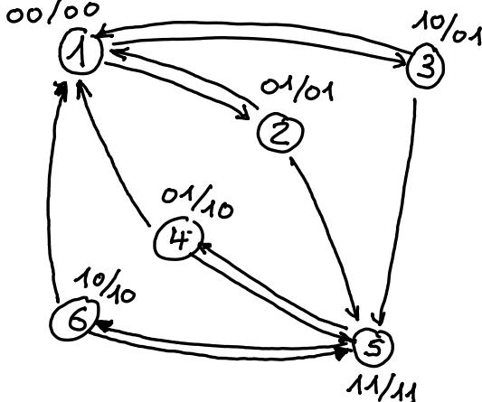
13. La valeur de la sortie  $F = E_1 \bar{E}_2 + \bar{S} \cdot (E_1 + E_2)$  figure sur le graphe de fluence à la q.12.
