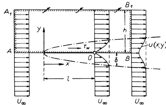
Le profil de vitesse immédiatement à l'arrière de la plaque (en  $O$  sur la figure ci-dessus) est constitué des deux profils des couches limites du dessus et du dessous de la plaque. Plus en aval, le liquide proche du plan de symétrie a été accéléré. Le creux du profil de vitesse s'élargit dans la direction transverse à l'écoulement, tandis que sa profondeur diminue. Nous nous intéressons à l'évolution asymptotique du profil de vitesse dans le sillage, en régime stationnaire.
