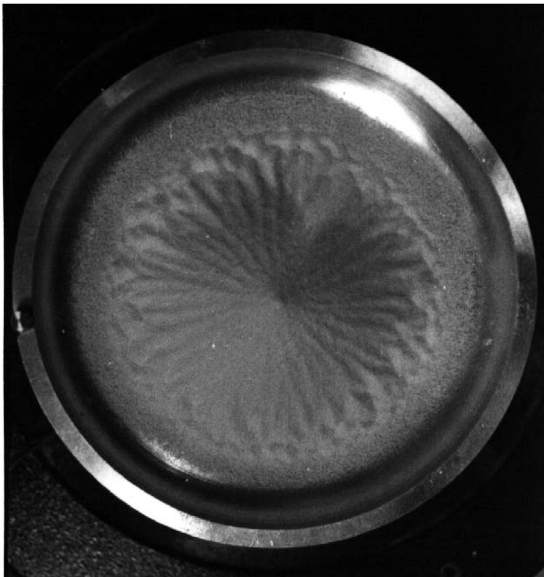
FIG. V-5 – Grossissement de la Fig. (V-2b) mettant en évidence la série successive de « rainures » et de « rides » à la surface du tas cannelé. Noter la présence des petits monticules, à la base du tas, à l'extrémité des rainures. A l'extrême gauche de la figure, on voit l'accéléromètre collé sur la partie haute du récipient.
